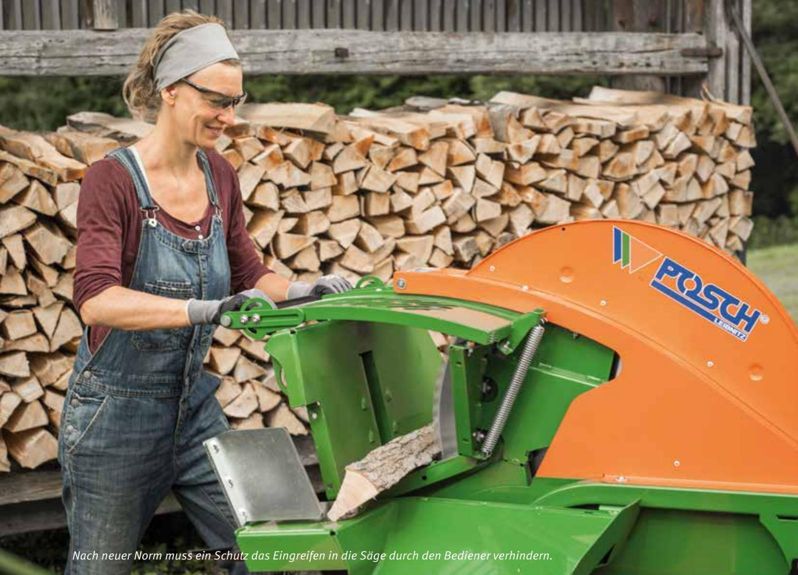
Nach neuer Norm muss ein Schutz das Eingreifen in die Säge durch den Bediener verhindern.
