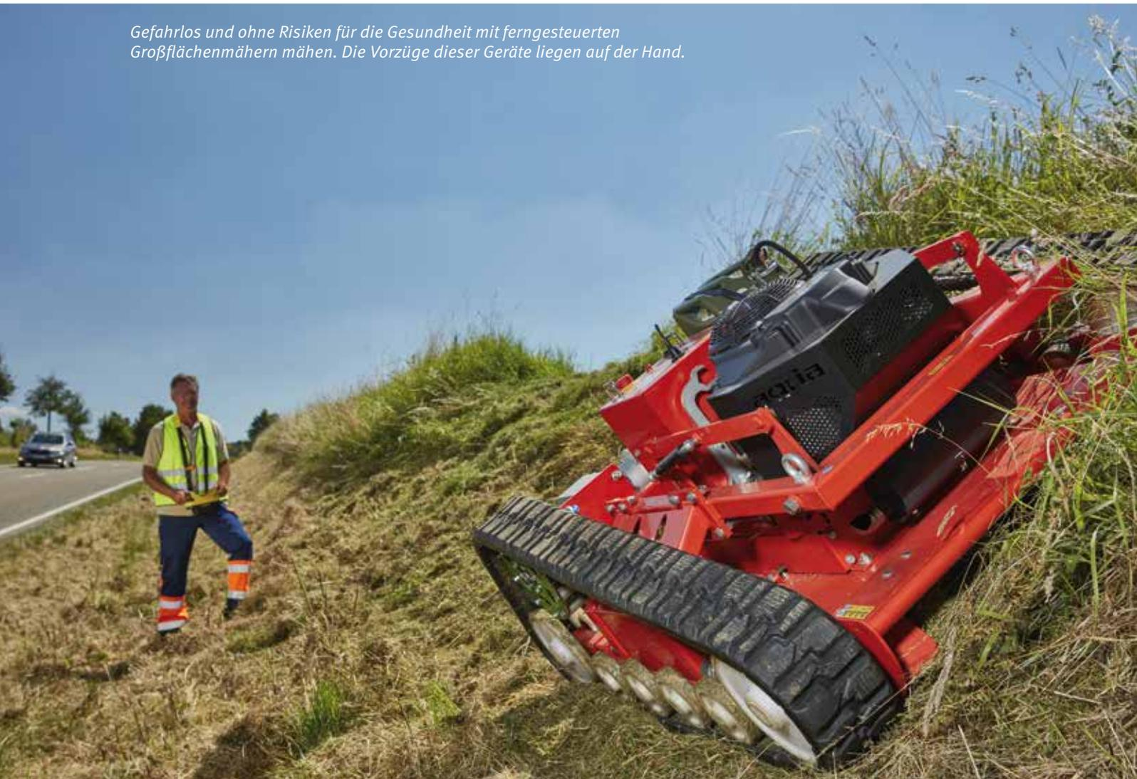
wicht von 250 kg und einer Flächenleistung von bis zu 3 000 m<sup>2</sup> je Stunde. Die großen Geschwister mähen bis zu 120 cm Breite bei einem Gewicht um die 500 kg bis zu 5 000 m<sup>2</sup> je Stunde. Überwiegend werden Benzinmotoren der gängigen Hersteller verbaut, vereinzelt sind aber auch hier schon Diesellaggregate im Angebot. Die meisten Maschinen bewältigen ohne weitere Hilfsmittel Hangneigungen von 50 bis 55°, also weit über 100%.
