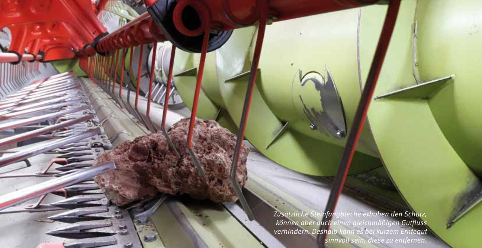
*Zusätzliche Steinfangbleche erhöhen den Schutz, können aber auch einen gleichmäßigen Gutfluss verhindern. Deshalb kann es bei kurzem Erntegut sinnvoll sein, diese zu entfernen.*
