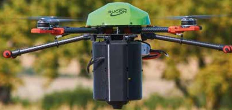
Ein Quadrocopter mit Dispenser-System bei der Ausbringung von Kapseln mit Eiern der Schlupfwespe zur Bekämpfung des Maiszünslers.
