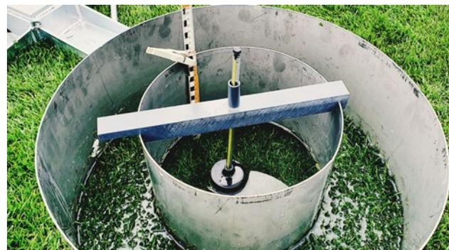
Messen der Wasserdurchlässigkeit des Bodens mit dem Doppelringinfiltrometer
